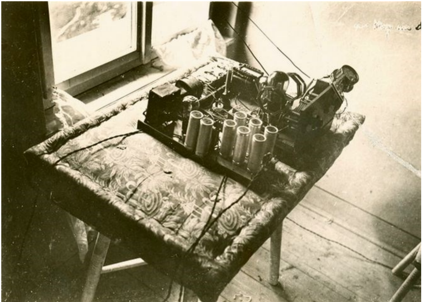
Formis Sender, wie von der Untersuchungskommission fotografiert, direkt in der Nr.18 in Záhori. Die Kraftübertragungsröhre ist immer noch an Ort und Stelle, einschließlich des Treibers (teilweise sichtbar hinter der Betriebslampe). Also, es war ein Einweg-Sender. (Postmuseum, Prag)
